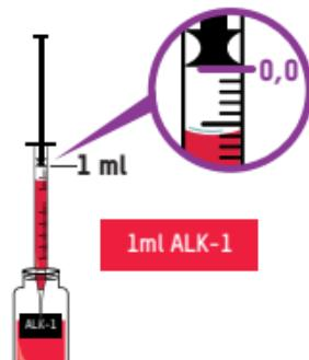
razione il bordo inferiore dell'anello nero dello stantuffo si deve trovare esattamente sulla marcatura di 0,0 ml (si veda la figura). Una piccola quantità d'aria sotto lo stantuffo non disturba la determinazione.
